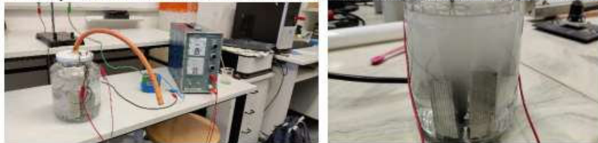
16-18. kép: Gergő otthon készített egy elektrolizáló berendezést, de benne durranógáz képződik
