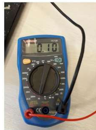
42- 43. kép: Újabb elektrolízis, 0,1A-es áramerősséggel
